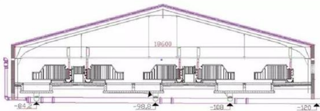
图 2.1-1 猪舍尿泡粪设计结构示意图
