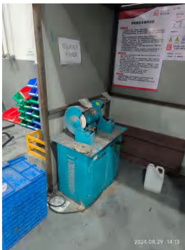
图4-8 砂轮机及其自带的滤芯除尘器照片
